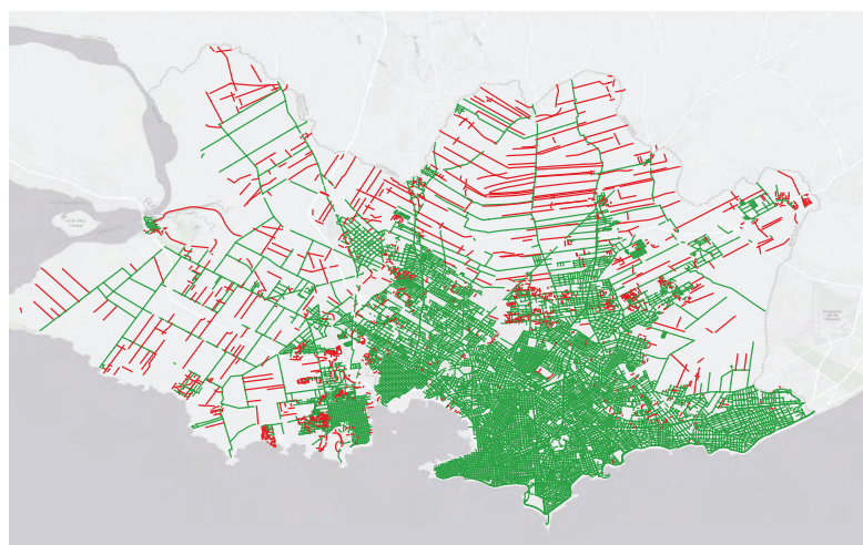
Panel B – Estado de la infraestructura vial
